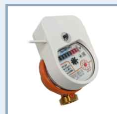
Квартирный счетчик воды «Пulsар Лайт» Ду15 RS-485, Qn=1,5 м3/ч, L=80мм, присоединители в комплекте
